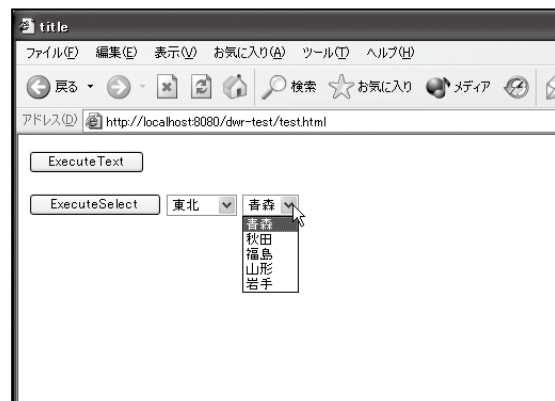
図6：“東北”を選択して getPrefs メソッド実行 都道府県がドロップダウンにセットされている
